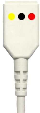
Abb. 40. Farbkodierte Anschlüsse an der Verteilerweiche des EKG-Patientenkabels
